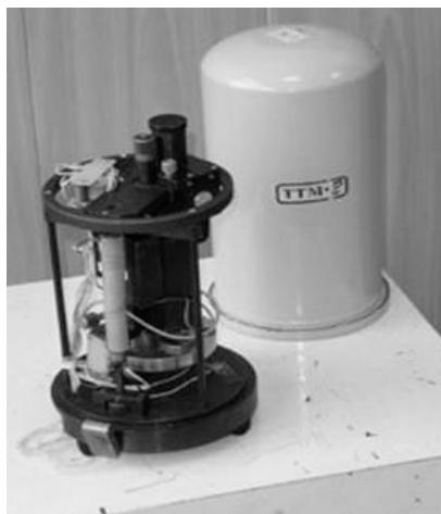
**Рис. 1.3.** Внешний вид микроскопа ТТМ-2, защитный колпак стоит рядом
