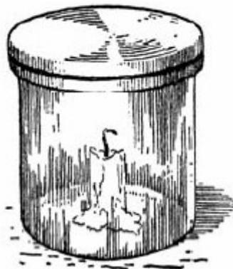
Рис. 56. Опыт со свечой в банке
