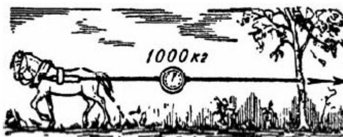
Рис. 63. Динамометр показывает силу тяги лошади или силу тяги дерева, С но никак не сумму обоих усилий
