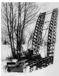
*Саперный танк СТ-26. Такие машины использовались в составе 35-й легкотанковой бригады (АСКМ).*
