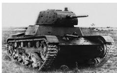
*Танк ХТ-134 на испытаниях в Кубинке летом 1940 года. Хорошо виден огнемет в верхнем переднем листе корпуса. Машина прибыла с Карельского перешейка, где участвовала в боях (АСКМ).*
