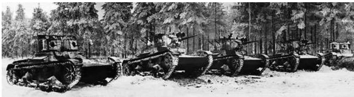
Танки Т-26 различных модификаций (с цилиндрическими башнями, поручневыми антеннами, зенитными установками и фарами для ночной стрельбы, а также двухбашенные пулеметные) из состава 35-й легкотанковой бригады на фронте. Февраль 1940 года (АСКМ).
