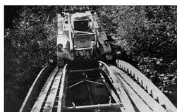
*Саперный танк СБТ на базе БТ-2. Эта машина действовала в составе 13-й легкотанковой бригады на Карельском перешейке (АСКМ).*
