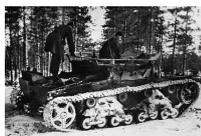
*Танк управления телемеханической группы «Подрывник» во время испытаний на Карельском перешейке. Март 1940 года. Хорошо видна конструкция модернизированной ходовой части (фото из коллекции Н. Гаврилкина).*
