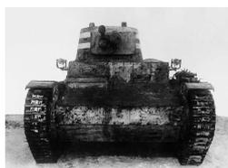
Трофейный финский танк «Виккерс», проходивший испытания на полигоне в Кубинке весной 1940 года, вид спереди и справа. В лобовом листе подбашенной коробки видна установка для крепления 9-мм пистолета-пулемета «Суоми», на башне нанесена бело-голубая полоса цветов флага Финляндии для отличия «виккерсов» от советских Т-26 (РГВА).
