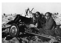
*Красноармейцы осматривают трофейную финскую 37-мм противотанковую пушку «Бофорс» PstK/36. Карельский перешеек, февраль 1940 года (АСКМ).*
