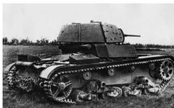
*Танк ХТ-134 на испытаниях в Кубинке. Летом 1940 года. На заднем листе подбашенной коробки виден бак для огнесмеси. Для снижения массы танка перед испытаниями, с нее демонтировали экранировку корпуса (АСКМ).*
