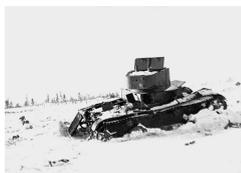
*Подбитый в районе высоты 65,5 телетанк ТТ-26 из состава 217-го отдельного огнеметного танкового батальона, февраль 1940 года. Хорошо видна деталь, характерная для телетанков – два антенных ввода на крыше башни (АСКМ).*
