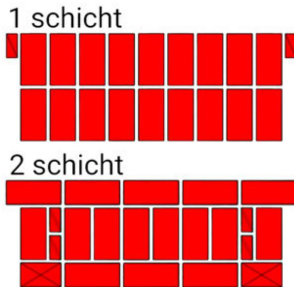
Fig.13. Die Reihenfolge des Legens eines Ziegelsteines in einem Abschnitt von Wänden zwischen Fensteröffnungen. Die Dicke der Mauer beträgt 2 Ziegel.
