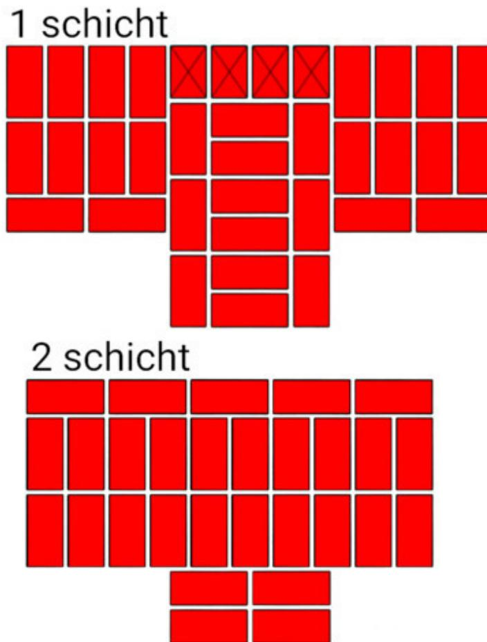
Fig.19. Die Reihenfolge der Ziegelsteine in den angrenzenden Wänden. Die Dicke der Wände beträgt 2,5 und 2 Ziegel.
