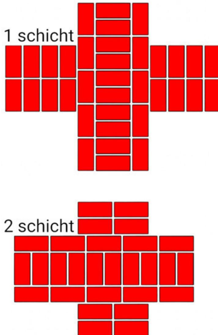
Fig.24. Die Reihenfolge des Legens des Ziegelsteines in der Kreuzung der Wände. Die Dicke der Wände beträgt 2 und 2 Ziegel.
