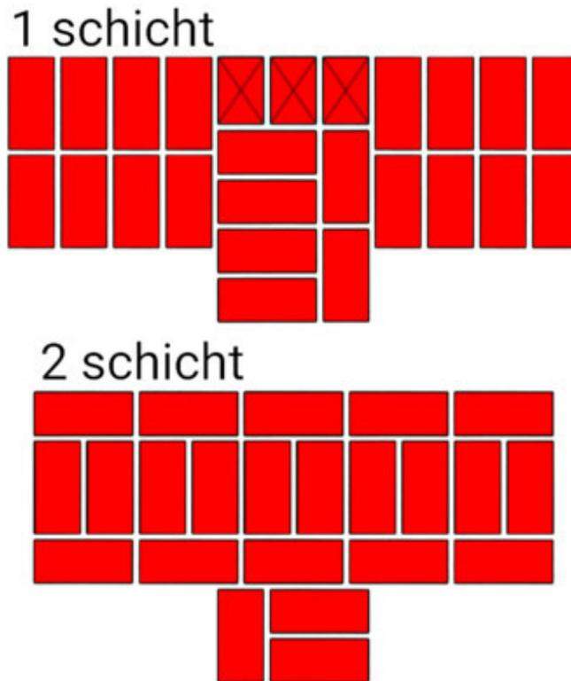
Fig.17. Die Reihenfolge der Ziegelsteine in den angrenzenden Wänden. Die Dicke der Wände beträgt 2 und 1,5 Ziegel.
