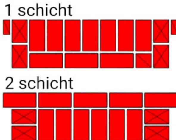
Fig.12. Die Reihenfolge des Legens eines Ziegelsteines in einem Abschnitt von Wänden zwischen Fensteröffnungen. Die Dicke der Mauer beträgt 1,5 Ziegel.
