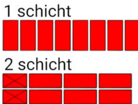
Fig.7. Die Reihenfolge der Mauersteine in der Mauer Einschränkung. Wandstärke 1 Ziegel.
