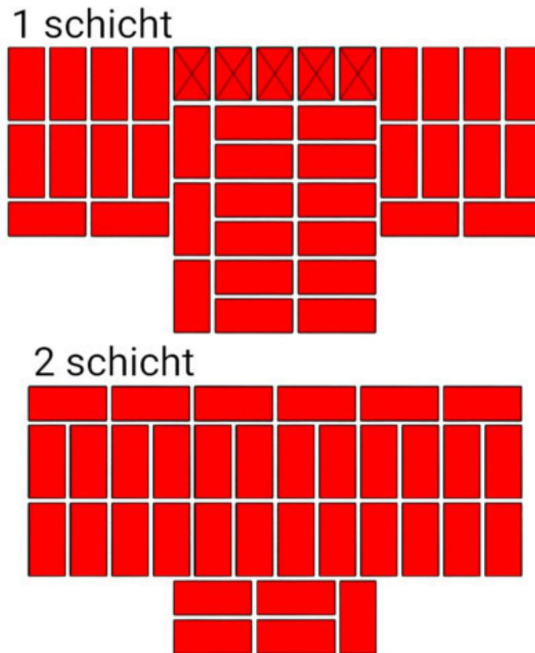
Fig.20. Die Reihenfolge der Ziegelsteine in den angrenzenden Wänden. Die Dicke der Wände beträgt 2,5 und 2,5 Ziegel.
