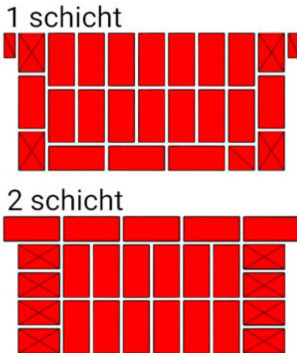
Fig.14. Die Reihenfolge des Legens eines Ziegelsteines in einem Abschnitt von Wänden zwischen Fensteröffnungen. Die Dicke der Mauer beträgt 2,5 Ziegel.
