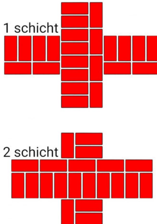
Fig.22. Die Reihenfolge des Legens des Ziegelsteines in der Kreuzung der Wände. Die Dicke der Wände beträgt 1,5 und 1,5 Ziegel.
