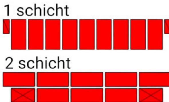
Fig.11. Die Reihenfolge des Legens eines Ziegelsteines in einem Abschnitt von Wänden zwischen Fensteröffnungen. Wandstärke 1 Ziegel.
