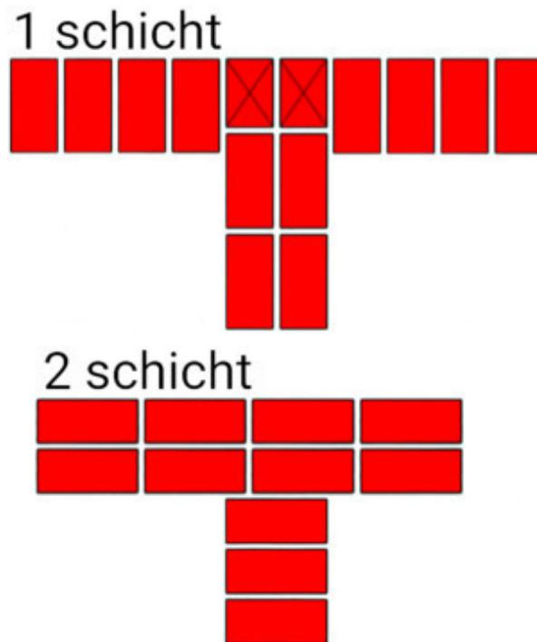
Fig.15. Die Reihenfolge der Ziegelsteine in den angrenzenden Wänden. Die Dicke der Wände beträgt 1 und 1 Ziegel.
