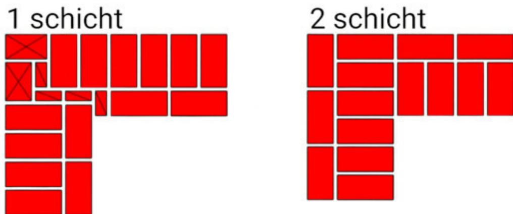
Fig.4. Die Reihenfolge des Legens eines Ziegelsteines in der Ecke der Wand. Die Dicke der Mauer beträgt 1,5 Ziegel.
