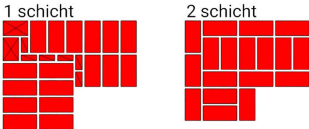
Fig.5. Die Reihenfolge des Legens eines Ziegelsteines in der Ecke der Wand. Die Dicke der Mauer beträgt 2 Ziegel.
