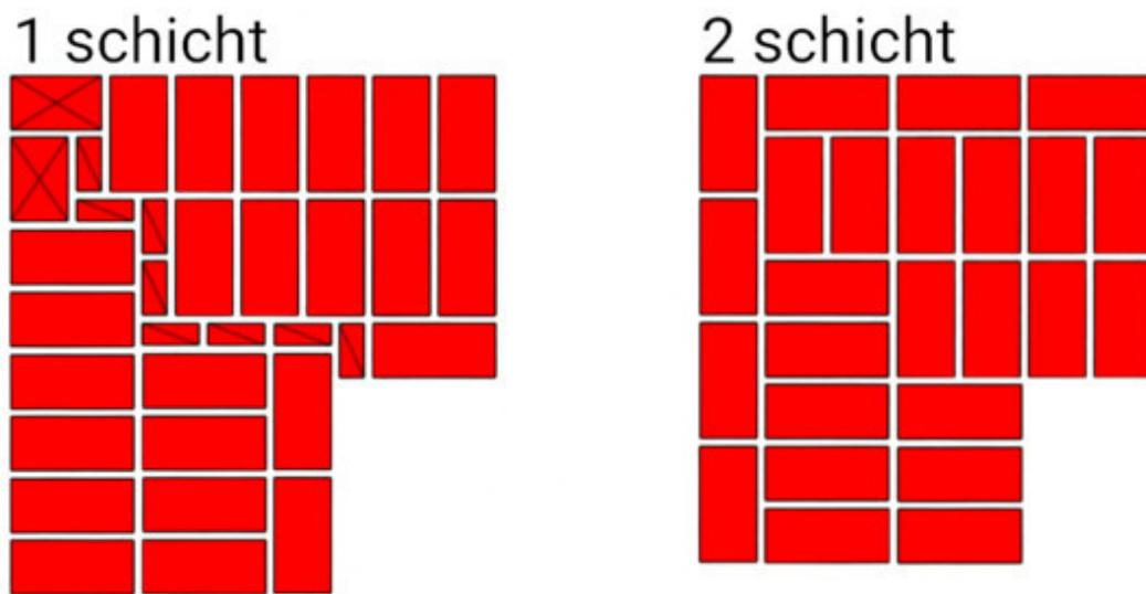
Fig.6. Die Reihenfolge des Legens eines Ziegelsteines in der Ecke der Wand. Die Dicke der Mauer beträgt 2,5 Ziegel.
