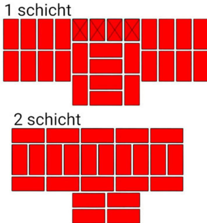
Fig.18. Die Reihenfolge der Ziegelsteine in den angrenzenden Wänden. Die Dicke der Wände beträgt 2 und 2 Ziegel.
