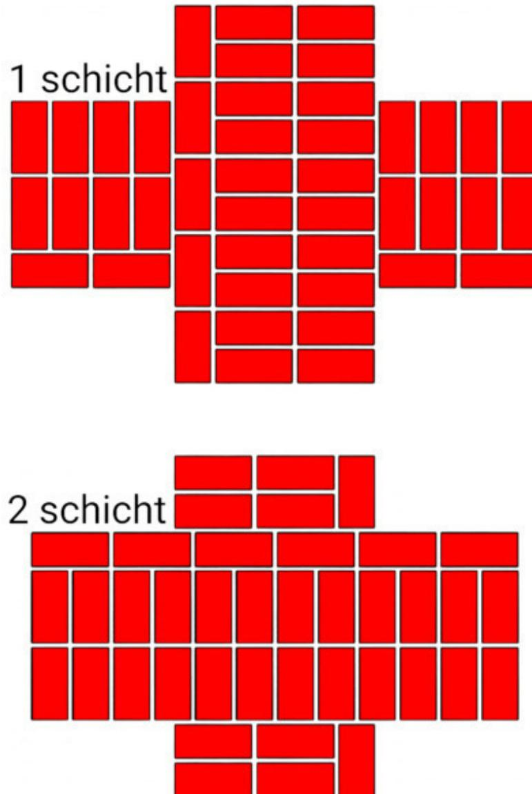
Fig.26. Die Reihenfolge des Legens des Ziegelsteines in der Kreuzung der Wände. Die Dicke der Wände beträgt 2,5 und 2,5 Ziegel.
