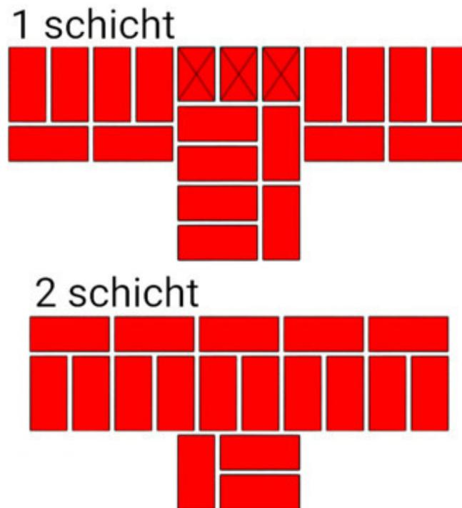
Fig.16. Die Reihenfolge der Ziegelsteine in den angrenzenden Wänden. Die Dicke der Wände beträgt 1,5 und 1,5 Ziegel.
