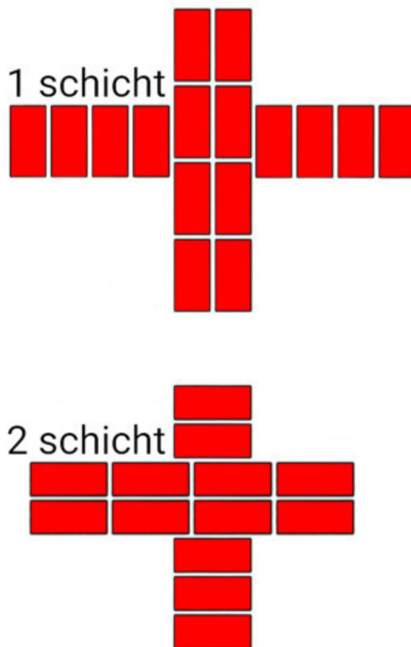
Fig.21. Die Reihenfolge des Legens des Ziegelsteines in der Kreuzung der Wände. Die Dicke der Wände beträgt 1 und 1 Ziegel.
