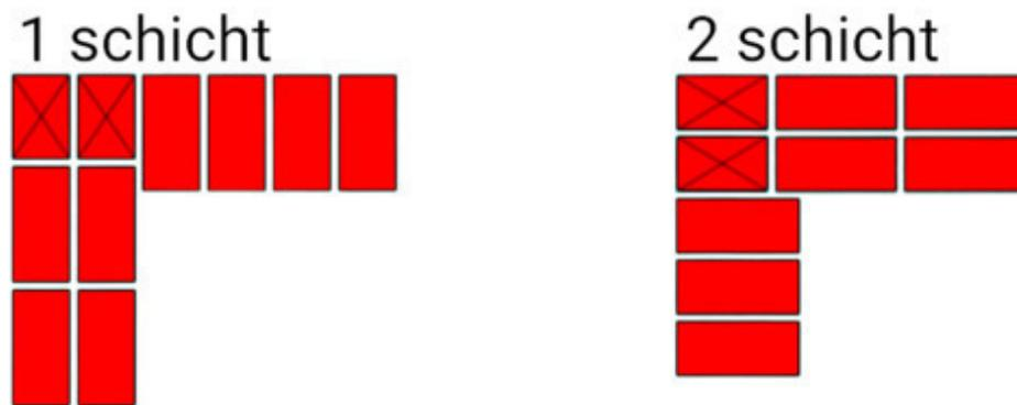
Fig.3. Die Reihenfolge des Legens eines Ziegelsteines in der Ecke der Wand. Wandstärke 1 Ziegel.
