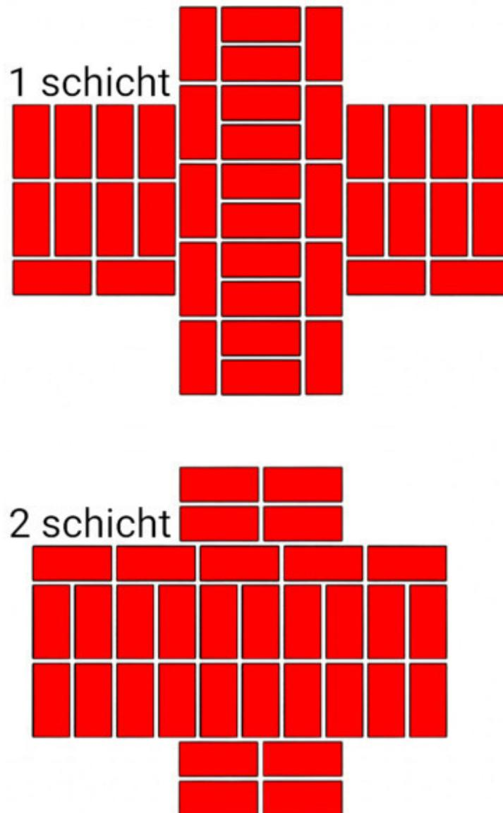
Fig.25. Die Reihenfolge des Legens des Ziegelsteines in der Kreuzung der Wände. Die Dicke der Wände beträgt 2,5 und 2 Ziegel.
