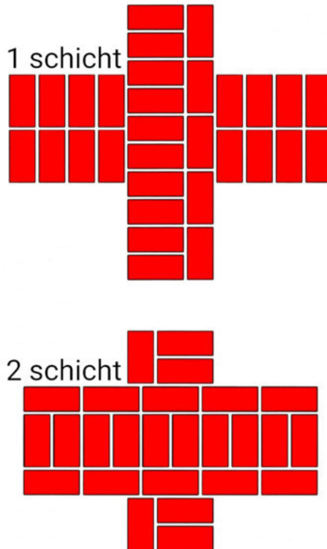
Fig.23. Die Reihenfolge des Legens des Ziegelsteines in der Kreuzung der Wände. Die Dicke der Wände beträgt 2 und 1,5 Ziegel.
