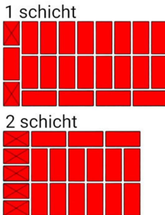
Fig.10. Die Reihenfolge der Mauersteine in der Mauer Einschränkung. Die Dicke der Mauer beträgt 2,5 Ziegel.
