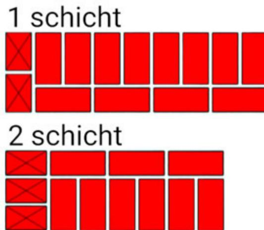
Fig.8. Die Reihenfolge der Mauersteine in der Mauer Einschränkung. Die Dicke der Mauer beträgt 1,5 Ziegel.
