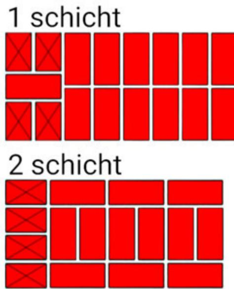
Fig.9. Die Reihenfolge der Mauersteine in der Mauer Einschränkung. Die Dicke der Mauer beträgt 2 Ziegel.
