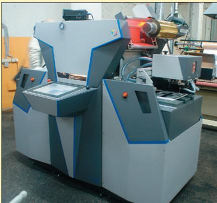
Машина имеет максимальный размер обрабатываемого листа 390x500 мм. Возможно изготовить машину под заказ любого формата — вплоть до 720x1040 мм. Цена представленной **DM-Liner** — около 100 000 евро. По желанию заказчика возможно увеличить длину листа, подлежащего металлизации (для изготовления баннеров и суперобложек), при этом цена вырастет незначительно
