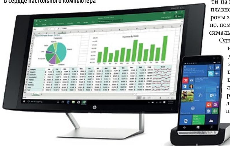
За сохранность данных отвечают две системы биометрической идентификации — по отпечатку пальца и сетчатке глаза и соответствие устройства классам защиты IP-67 и MIL-STD 810G, поддерживается широкий набор стандартов шифрования данных, в том числе FIPS 140-2, SecureBoot, 128-битный ключ Unified Image Encryption, 256-битный ключ Full Disk Encryption. Размеры x3 — 161,8x83,5x7,8 мм, масса — 195 г.
