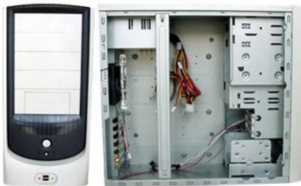
Рис. 1.2. Корпус ATX
