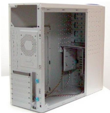
Рис. 1.7. Отсеки под трех- и пятидюймовые устройства
