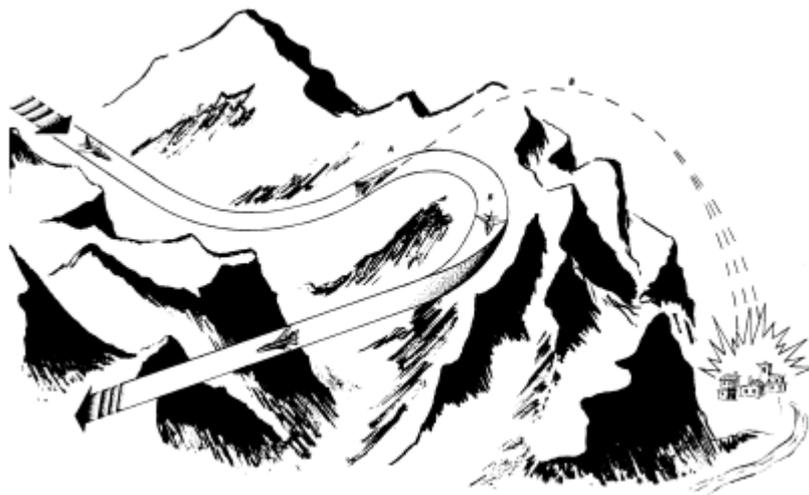
Бомбометание с кабрирования: удар с кабрирования мог быть использован для поражения цели с известным местоположением, обычно площадной, размерность которой позволяла накрыть ее со сбросом бомб по расчету. Разогнавшись в пологом снижении (А), самолет выполнял горку (Б) с углом 25–30° (или до 45°) с отделением бомб в верхней точке и отворачивал в сторону, оставаясь вне зоны ПВО или избегая входа в узкое ущелье. Бомбы уходили вверх (В) по траектории, пролетая к цели еще несколько километров
