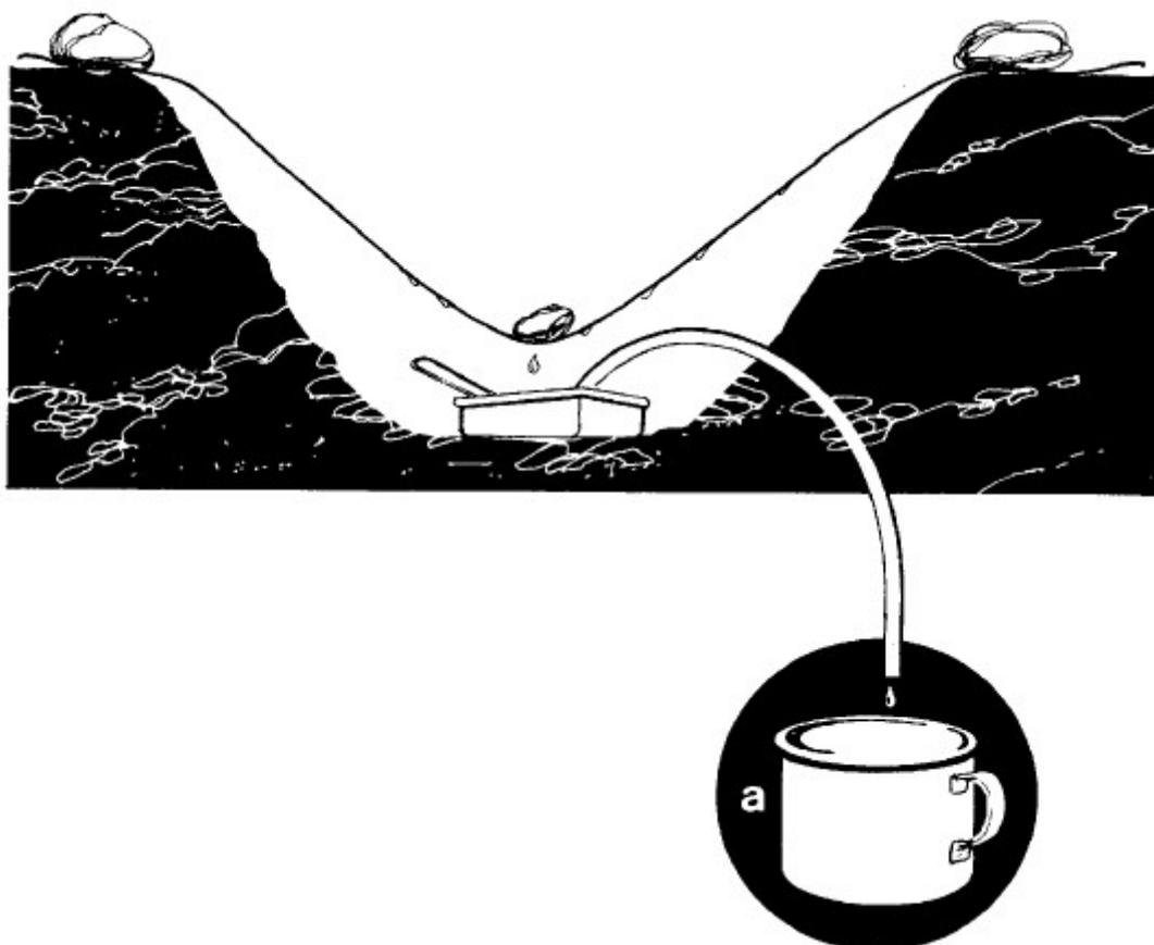
*Камнем придайте шероховатость нижней поверхности пленки, чтобы заставить воду стекать по ней вниз. Воспользуйтесь камнями или другими грузами для закрепления края пленки и придания ей формы конуса. Закрепите резервуар, чтобы попавшаяся живность не перевернула его.*
