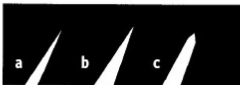
*Сечение режущей кромки: (a) слишком острый угол, клинок может зазубриваться, (b) правильно и (c) слишком тупой угол, быстро затупится и изнашивается.*
