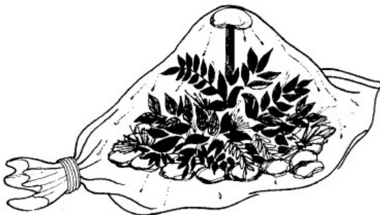
*Даже срезанные растения дадут определенную конденсацию, по мере того как будут нагреваться, будучи помещенными в большой пластиковый мешок. С помощью камней сделайте так, чтобы листья не касались дна мешка и воды, которая будет собираться под ними. Опять же с помощью камней держите тент в натянутом состоянии. Подоприте его палкой с прокладкой. Установите тент на небольшом склоне так, чтобы вода стекала к месту ее сбора. После того как образование воды прекратится, смените ветки с листьями.*
