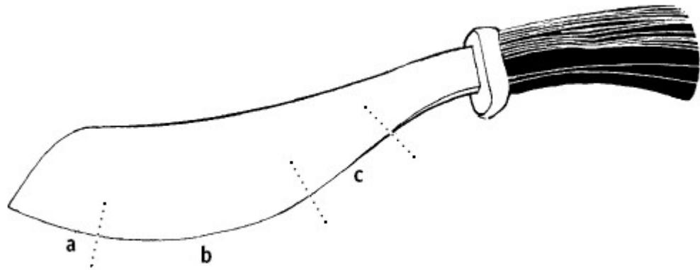
*У клинка паранга три разные режущие кромки: *b* – предназначена для тяжелого режима работы при рубке деревьев или костей, *a* – более тонкая и применяется для свежесечения, *c* – еще тоньше и служит для более аккуратных работ. Секции *a* и *c* затачиваются легко; кромка *b* тоже острая, но не настолько, чтобы легко тупиться или обламываться.*
