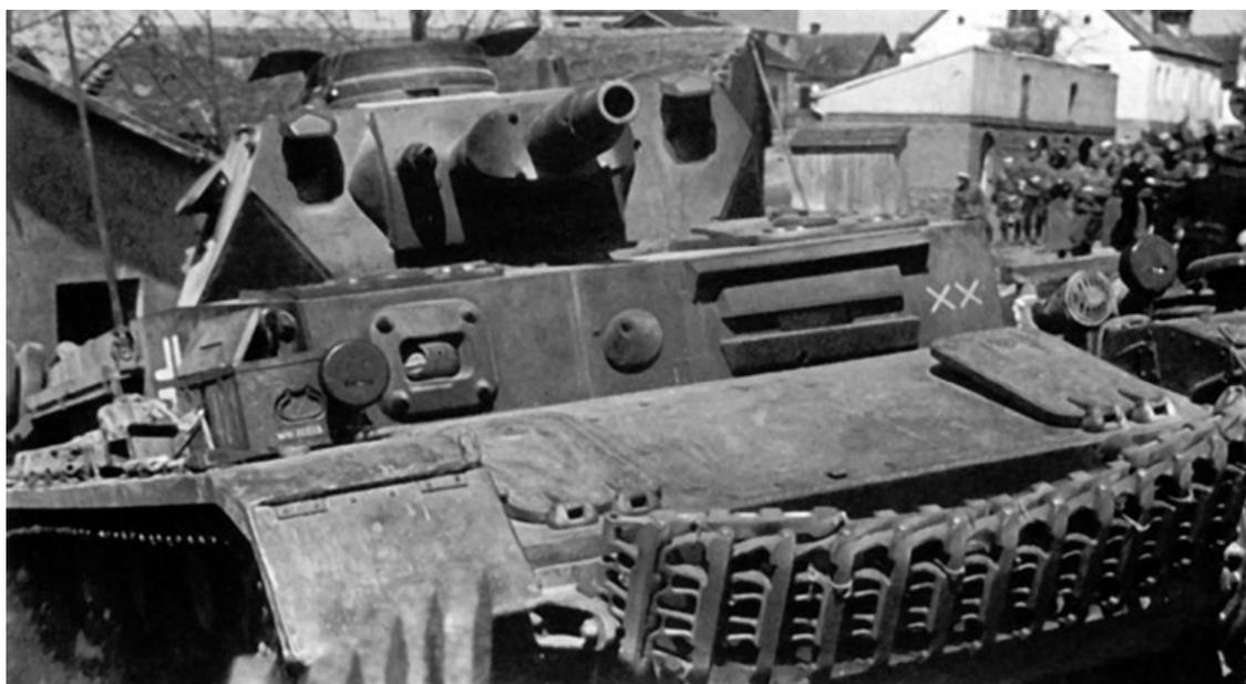
Танк Pz.IV 6-й танковой дивизии. Фрагмент гусеничной цепи давал дополнительную защиту машины.
