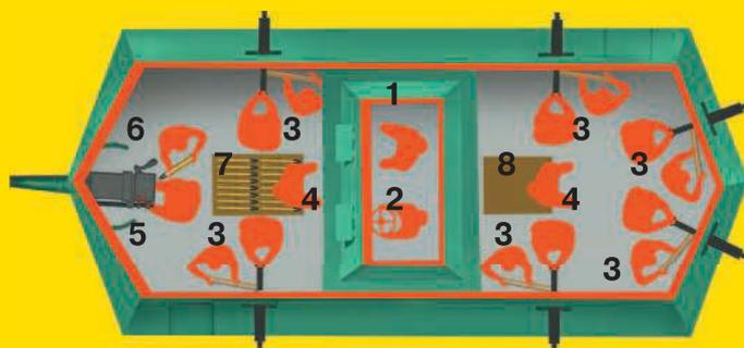
Размещение в танке A7V членов экипажа и боеприпасов:
