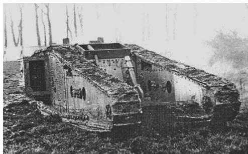
*Для улучшения проходимости часть танков Mk.IV получила удлиненные гусеничные обводы. Танкисты прозвали такие машины «тедпол» (головастик). На изображенной здесь машине между задними выступами гусеничных обводов установлен миномет*
