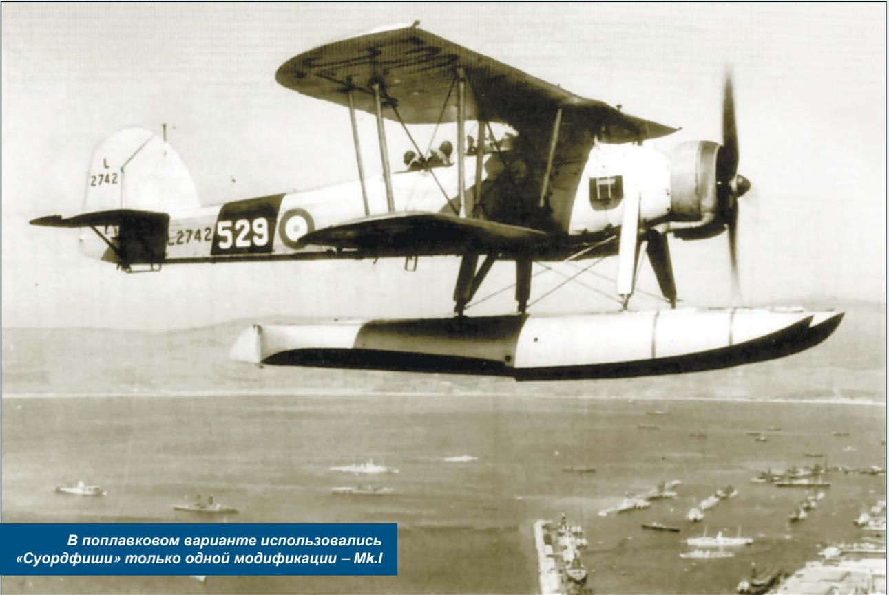
*В поплавковом варианте использовались «Суордфиши» только одной модификации – Mk.I*
