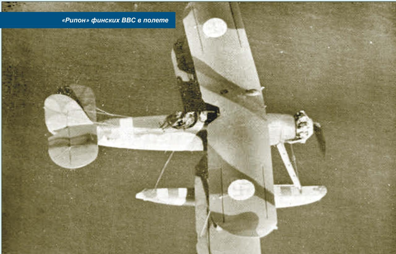
Одномоторный двухместный биплан смешанной конструкции, разрабатывавшийся с 1923 г. в соответствии с требованиями 21/23 к торпедоносцу-разведчику, способному эксплуатироваться как с колесным шасси (в т.ч. в качестве палубного самолета), так и с поплавковым. Разработка велась
