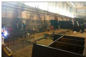
Производство всех типов защитно-охранных ограждений организовано на поточной линии с использованием полуавтоматических сварочных аппаратов
