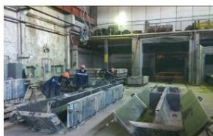
Для изготовления опорных блоков-фундаментных блоков специального сечения используется форма блока ФБС 24-4-6
