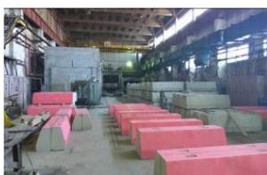
На предприятии организовано изготовление опорных бетонных блоков специального сечения для защитно-охранного ограждения ЗБ Н (1)
