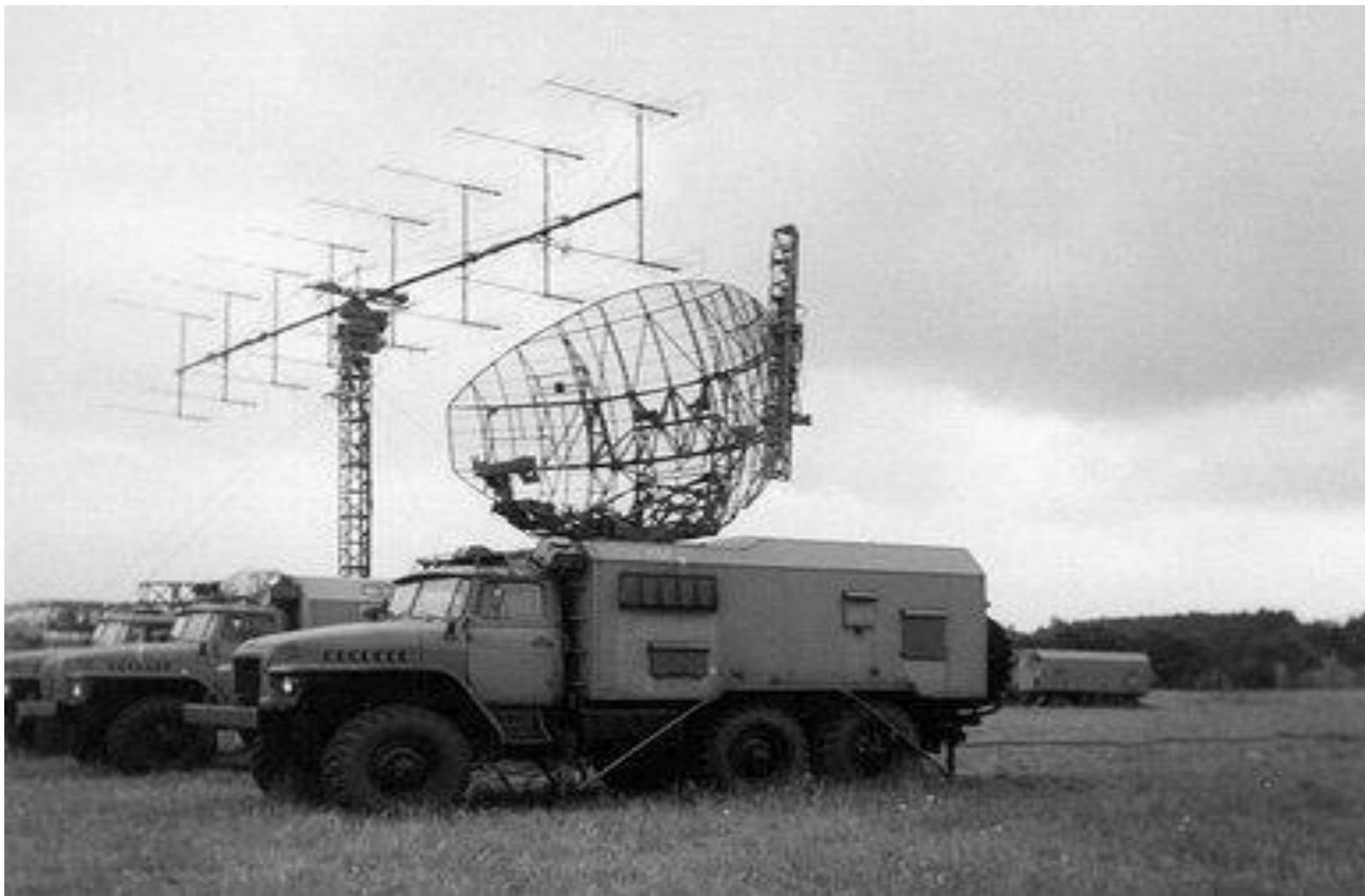
Рис. 1.3. Общий вид радиолокационной станции П-18Р
