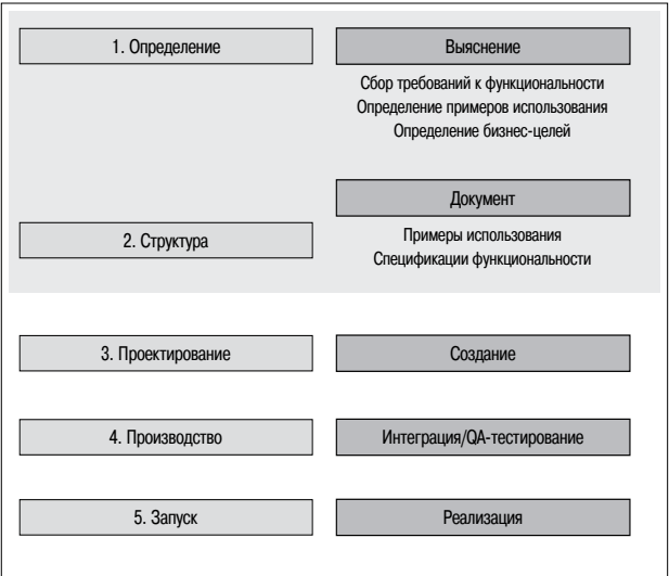
Рис.9.8. Эта схема, изображающая традиционный Базовый процесс (слева) и параллельную технологию внутреннего программирования (справа), четко определяет места их пересечения на протяжении всего Базового процесса
