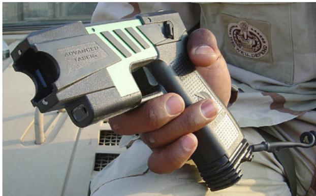
Тэйзер-M26 – один из видов дистанционного электрошокового оружия
