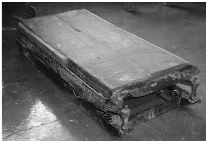
Рис. 1 Тензодинамографическая платформа
