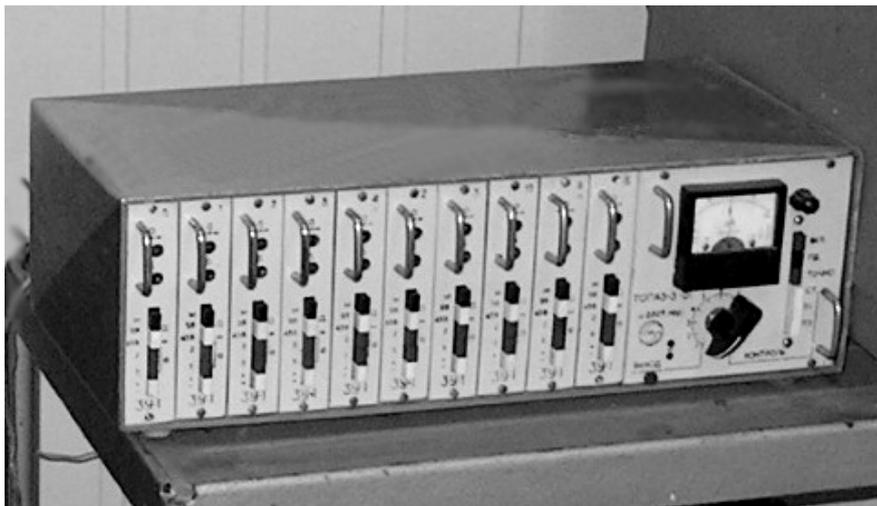
Рис. 5. 10-канальный вариант тензоусилителя «Топаз»
