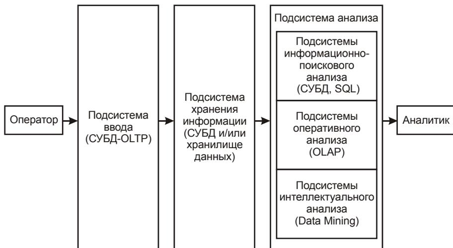
Рис. 1.2. Обобщенная архитектура системы поддержки принятия решений
