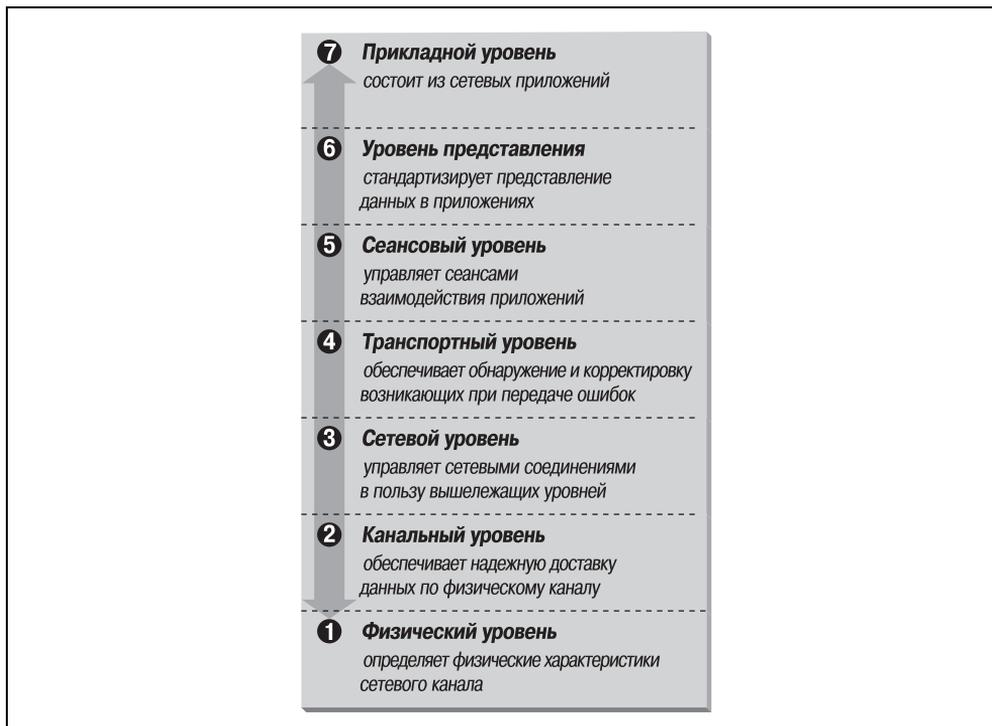
Рис. 1.1. Опорная модель OSI
