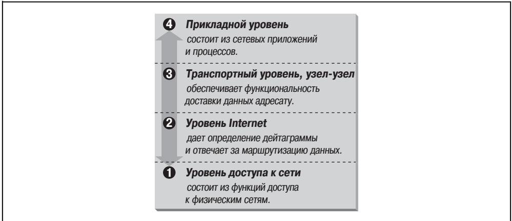
Рис. 1.2. Архитектура TCP/IP
