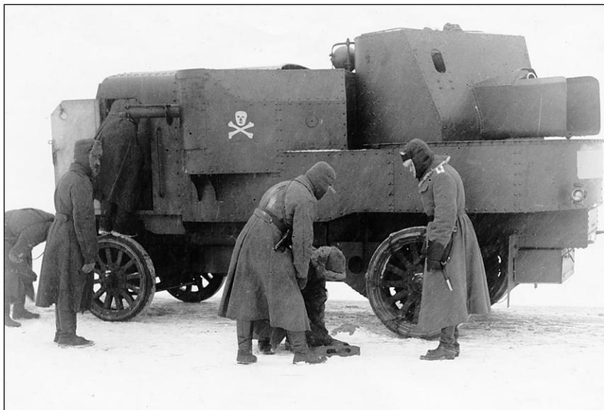
машинами русской армии того времени. Базой для них послужило легковое шасси «колониального типа» с двигателем 30 л.с. Они были защищены броневыми листами толщиной 3,5–4 мм, имели экипаж 4 человека (командир, водитель и два пулеметчика), их боевой вес составлял 166 пудов (2650 кг), а цена казне достигала 1150 фунтов стерлингов. Но изготавливались они не только за рубежом. После получения первой партии машин русские военные сочли их бронирование слабым и провели перебронирование 7-мм броневыми
