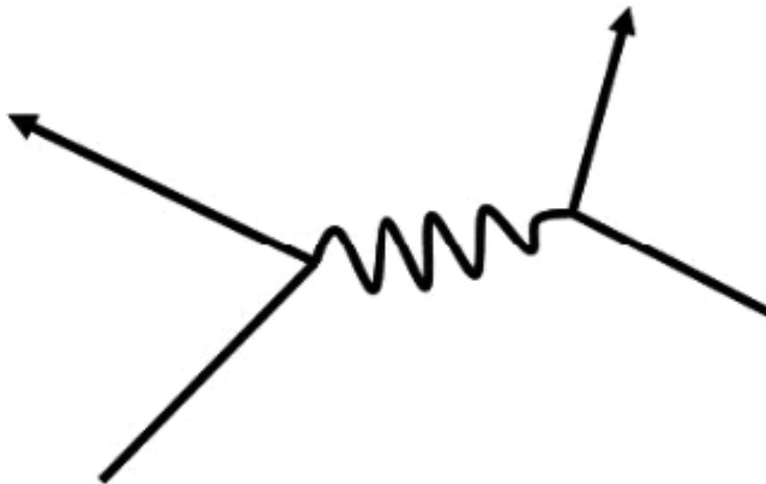
Рис. 15. Взаимодействие двух фермионов (например, электронов). Каждый электрон представлен прямой линией. Они обмениваются виртуальной частицей фотоном (извилистая линия) и отталкиваются друг от друга
