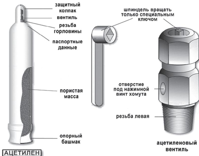
Рисунок 1.3. Ацетиленовый баллон и его вентиль
