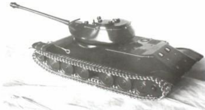
Деревянная модель одного из вариантов модернизации танка ИС, общие виды. Впоследствии наработки по этому танку послужили основой для разработки танка ИС-6 (АСКМ).
