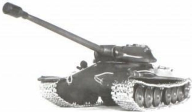
Деревянная модель одного из вариантов модернизации танка ИС, общие виды. Впоследствии наработки по этому танку послужили основой для разработки танка ИС-6 (АСКМ).
