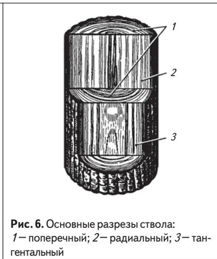
**Рис. 6.** Основные разрезы ствола: 1 – поперечный; 2 – радиальный; 3 – тангентальный
