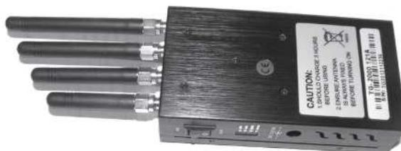
Рис. 1.2. Электронное устройство-«глушилка» по радиоканалу
