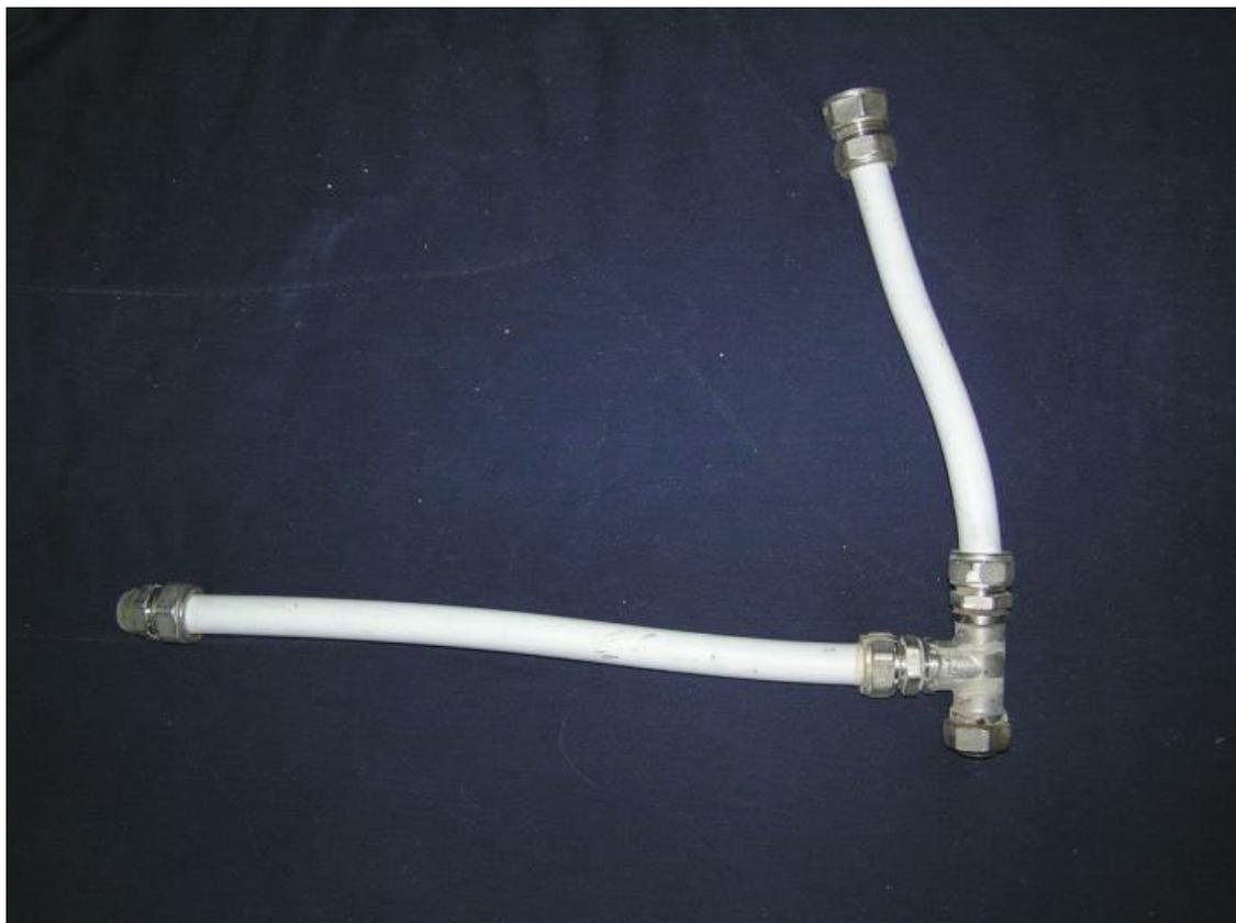
**Рис. 1.9.** Подготовленная перемычка из полипропиленовых труб
