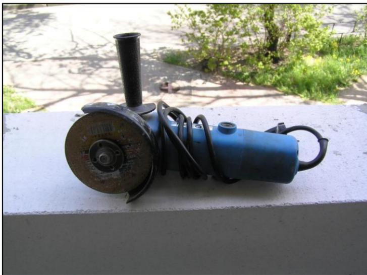
**Рис. 1.10.** Портативная болгарка с диском диаметром 115 мм
