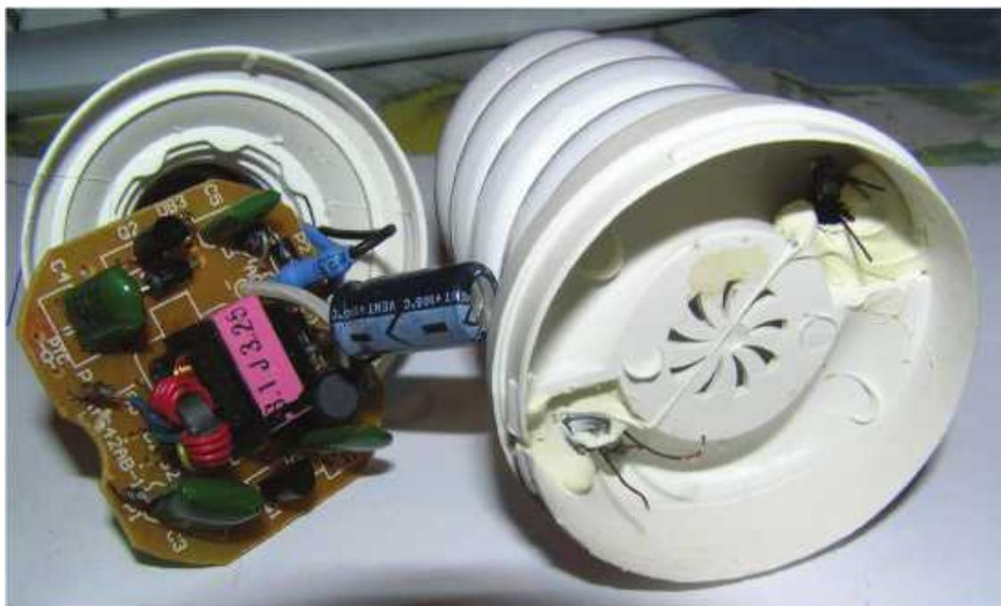
Рис. 1.4. «Начинка» энергосберегающей лампы
