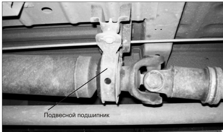
**Рис. 1.3.** Длинный карданный вал с подвесным подшипником
