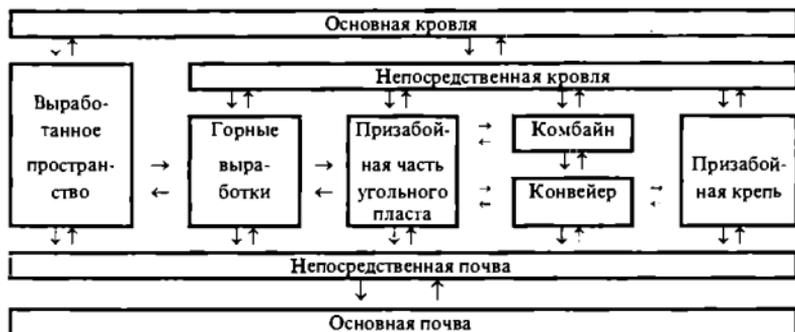
Рис. 1.1. Схема физического взаимодействия горнотехнических элементов выемочного участка
