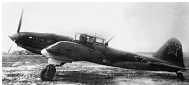
*Серийный самолет Ил-2 с мотором АМ-38ф*
