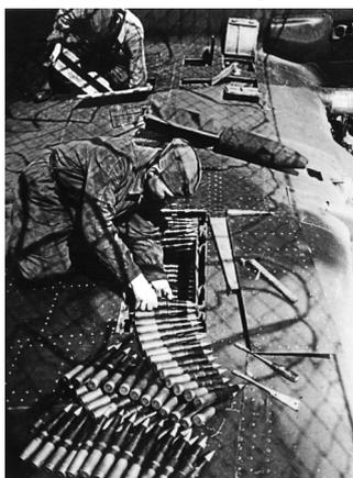
*Укладка ленты к пушке ВЯ-23 в снарядный отсек крыла самолета Ил-2*
