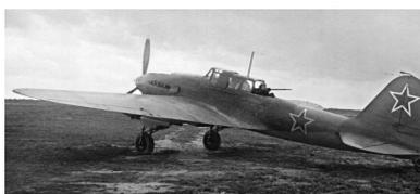
*Ил-2 АМ-38ф с турельной установкой УБШ конструкции завода № 487 НКАП под пулемет УБТ. Государственные испытания, июнь 1944 г.*
