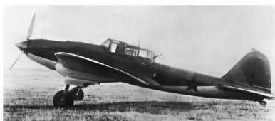
*Двухместный Ил-2 АМ-38 (зав. № 897) с пулеметом ЛЛ1КАС на турели производства завода № 30. Государственные испытания, октябрь 1942 г.*
