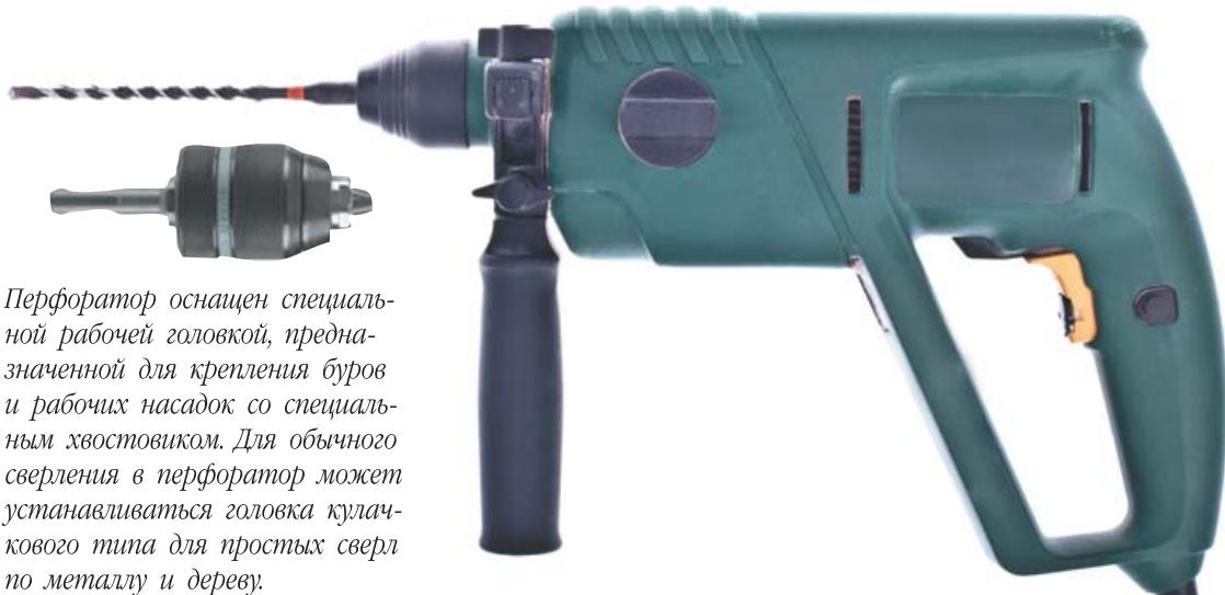
Перфоратор оснащен специальной рабочей головкой, предназначенной для крепления буров и рабочих насадок со специальным хвостовиком. Для обычного сверления в перфоратор может устанавливаться головка кулакового типа для простых сверл по металлу и дереву.
