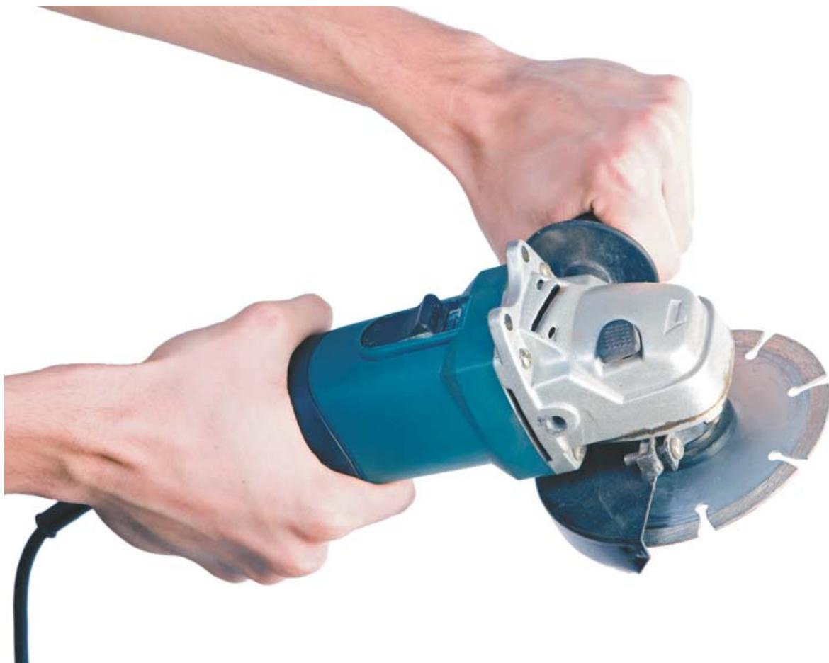
Угловая шлифовальная машинка используется для резки металла, кирпича и бетона. С ее помощью также зачищают и шлифуют различные поверхности. Такой инструмент незаменим при монтаже скрытой проводки в помещениях с бетонными или кирпичными стенами (для выполнения штроб). Сегодня рынок предлагает широкий выбор шлифмашинок различного размера, мощности и функциональных особенностей. Для дома вполне достаточно небольшого инструмента с диаметром круга 125 мм.
