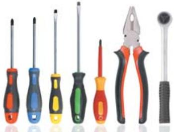
Электротехнические отвертки применяются при сборке электрооборудования и для соединения проводов при помощи винтовых зажимов. Лучше всего иметь стандартный набор плоских и крестовых отверток, предназначенных для работы в электроустановках с напряжением до 1000 В и снабженных соответствующей маркировкой. Отвертки с намагниченными наконечниками существенно облегчают работу при выполнении многих операций.
