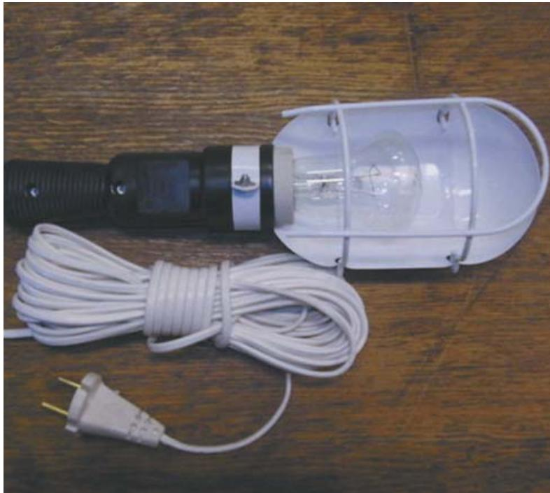
Переносной светильник предназначен для местного освещения рабочей зоны. Прибор должен быть оснащен выключателем и защитным кожухом. Такой светильник часто используется для проверки розеточной группы на работоспособность.
