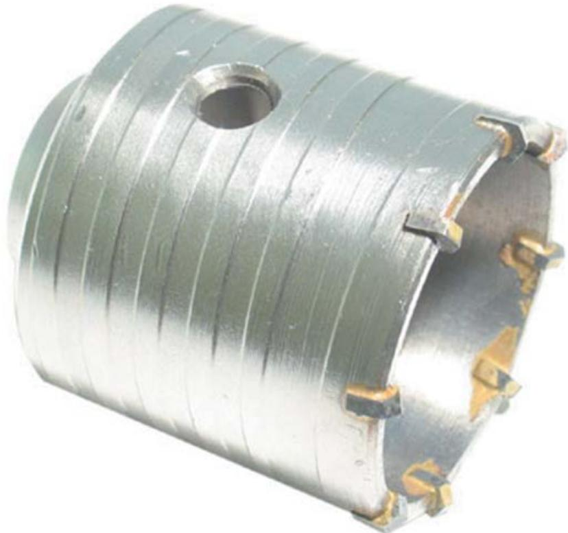
Для высверливания углублений под розетки и выключатели перфоратор оснащается специальной коронкой нужного диаметра, которая снабжена шестью твердосплавными пластинами и может работать в режиме удар–вращение.
