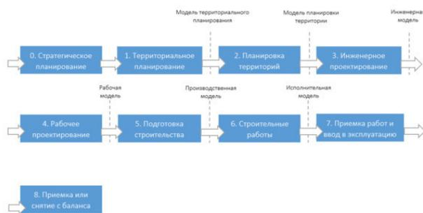
Рисунок 4. Модель жизненного цикла типовых дорожных проектов.
