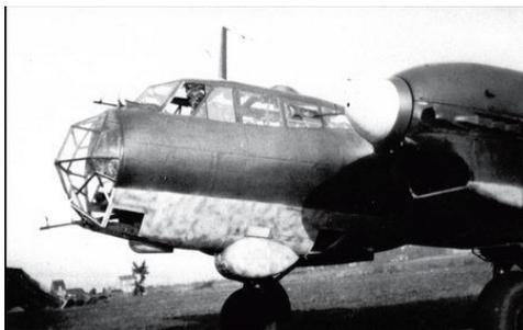
*Do-215B-4 из 4-й эскадрильи Aufkl.Gr.Ob.d.L., аэродром Мервиль, Франция, осень 1940 г. Под носовой частью фюзеляжа виден обтекатель объектива аэрофотокамеры Rb 50/30*
