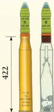
Выстрелы к 37-мм противотанковой пушке Pak 35/36; с осколочно-трассирующей гранатой
