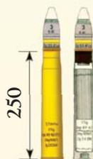
Надкалиберная кумулятивная граната Stielgranate 41 для 37-мм противотанковой пушки Pak 35/36
