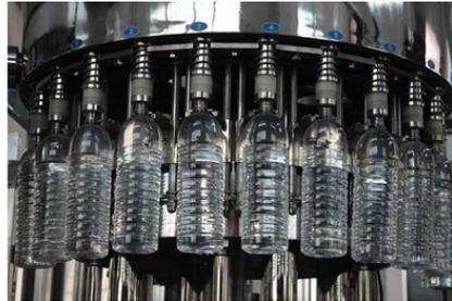
Рис. 2.8. Автомат по разливу жидкостей
