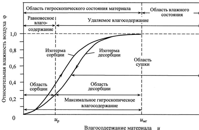
Рис. 1.1. Схема классификации состояния материала в процессе сушки
