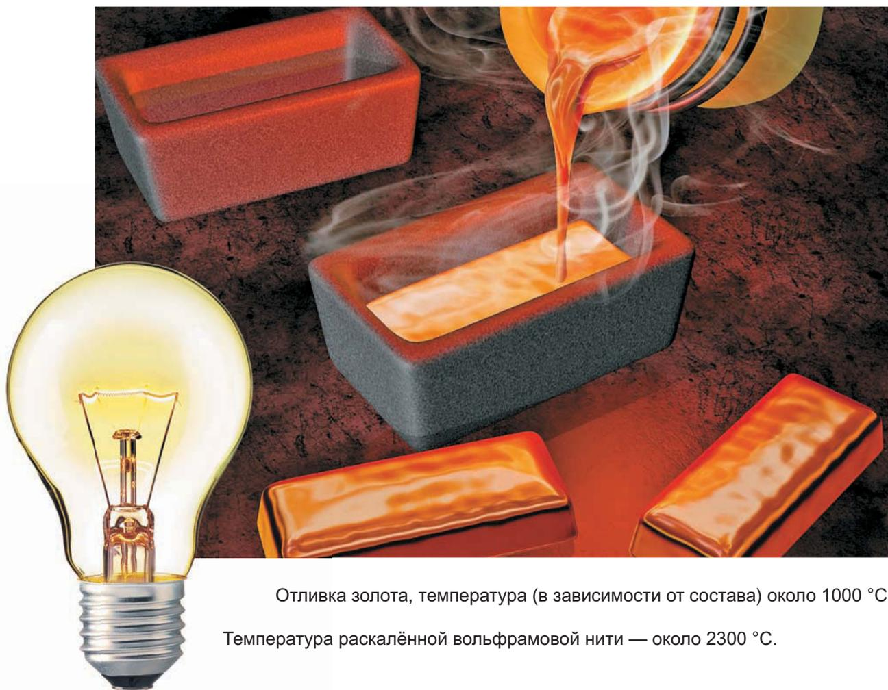
Отливка золота, температура (в зависимости от состава) около  $1000\text{ }^{\circ}\text{C}$ .
