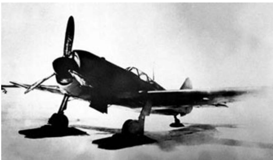
*Истребитель Ла-11 на лыжах. Лыжи имели сверху специальное гнездо для свободного захода самолёта на колёсах, фиксировавшихся упорами с полукруглыми вырезами.*
