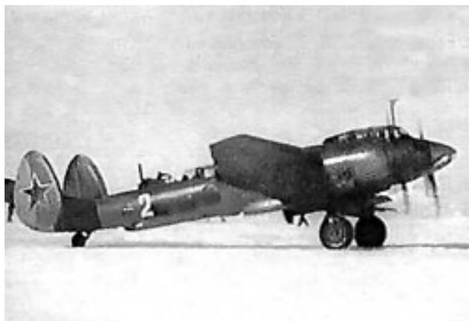
*Ту-6 – первый в СССР фоторазведчик, строившийся серийно, и лидер истребителей Ла-11 в полётах на арктические аэродромы*
