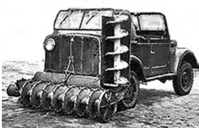
*Ледово-фрезерная машина ЛФМ-ГПИ-29 для строительства ледовых аэродромов в 1956 году проходила государственные испытания на дрейфующей станции «Северный полюс-6»*
