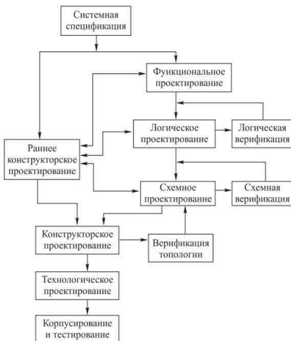
Рис. 1.1. Структура проектирования СБИС
