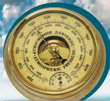
Барометр — прибор для измерения атмосферного давления.
