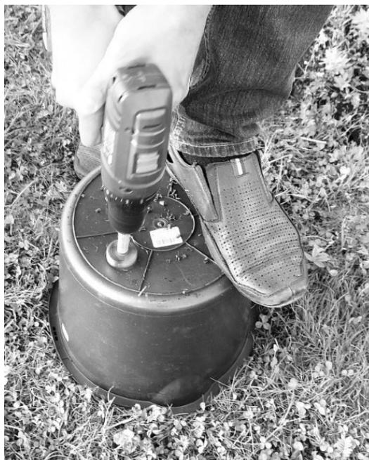
Дренажные отверстия любого диаметра в пластиковых ведрах очень удобно делать с помощью дрели. Для цинковых ведер я просто использую топор: аккуратно прорубаю много небольших отверстий в дне.
