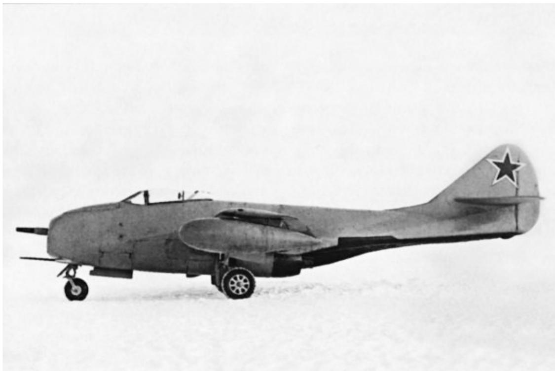
Серийный МиГ-9 с подвесными топливными баками на концах крыла
