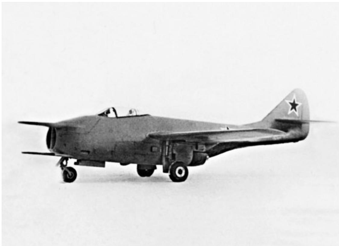
Пытаясь снизить влияние пороховых газов на работу силовой установки истребителя МиГ-9, 37-миллиметровую пушку расположили около верхней обечайки воздухозаборника
