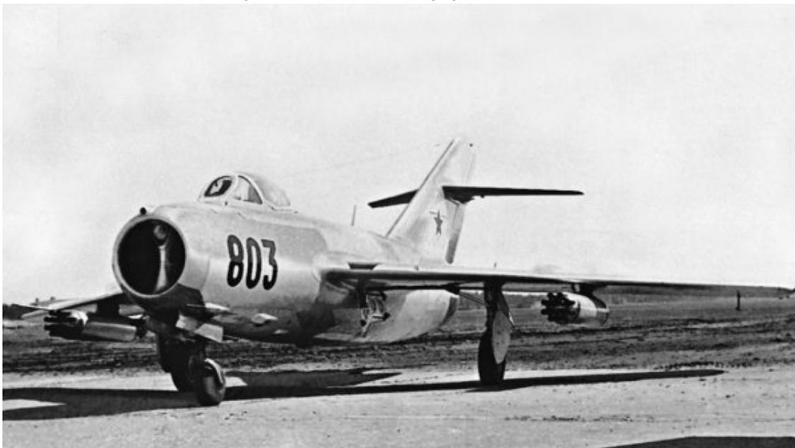
Самолет СД-5 с реактивными орудиями для неуправляемых реактивных снарядов С-5
