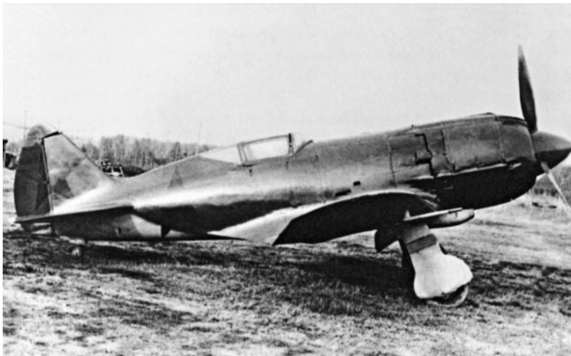
Опытный истребитель И-210 с мотором М-82
