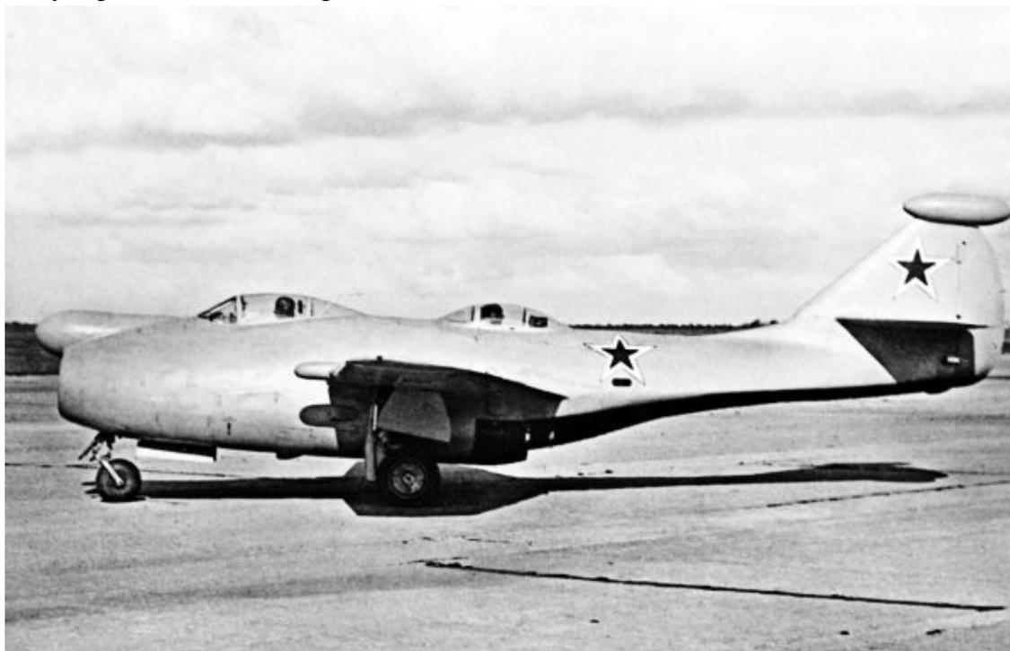
Самолет «ФК» – летающая лаборатория для отработки системы наведения крылатой ракеты «КС» («Комета»)
