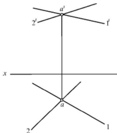
Рис. 27. Проекция прямых I и II на горизонтальную и фронтальную плоскости
