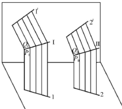
Рис. 29. Горизонтальная и фронтальная проекции параллельных прямых
