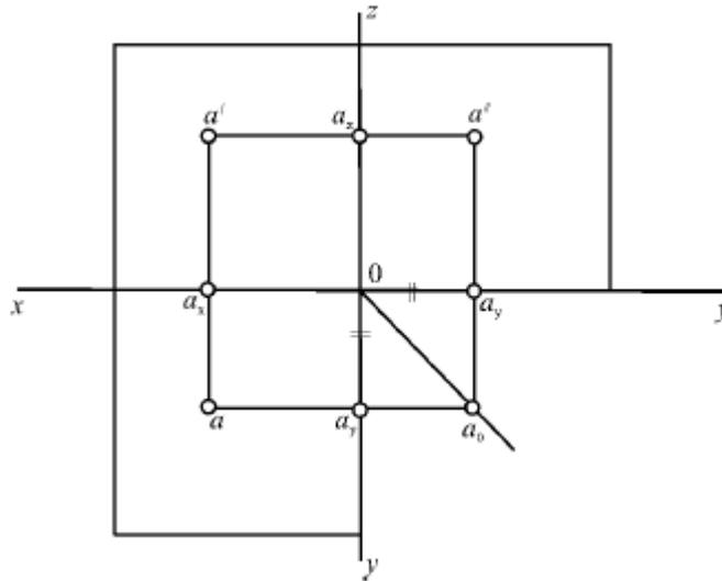
Рис. 16. Положение проекций  $a$ ,  $a'$  и  $a''$  точки  $A$
