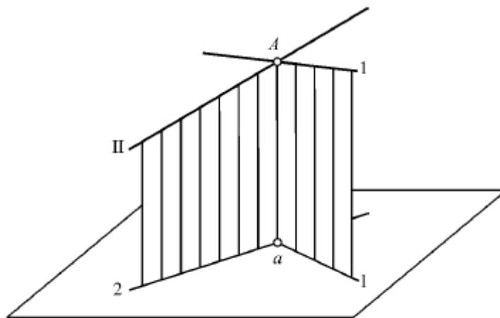
Рис. 26. Проекция прямых I и II на горизонтальную плоскость
