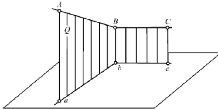
Рис. 32. Проекция угла  $ABC$
