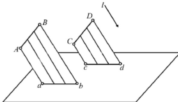
Рис. 3. Параллельная проекция предмета
