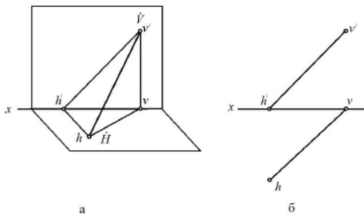
Рис. 21. Горизонтальный (а) и фронтальный след прямой
