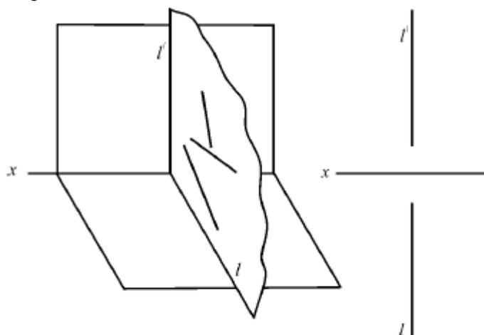
Рис. 25. Две проекции профильной прямой
