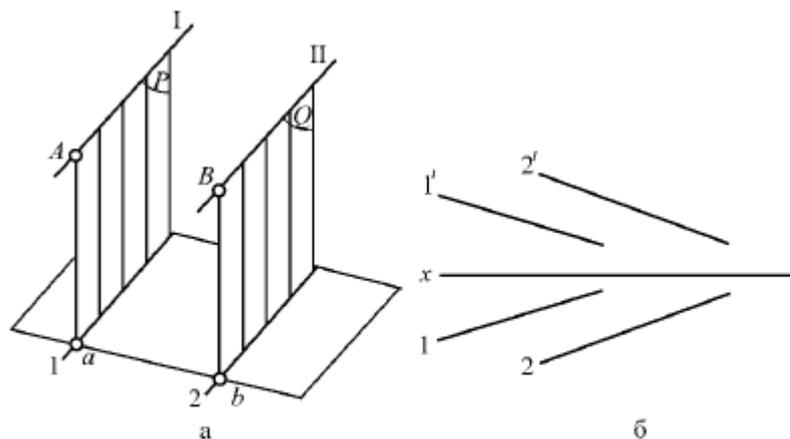
Рис. 28. Проекция параллельных прямых
