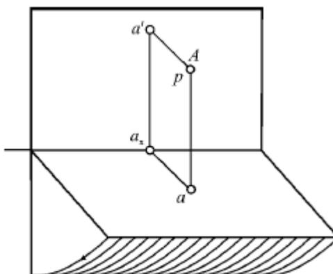
Рис. 4. Проекция точек на две плоскости
