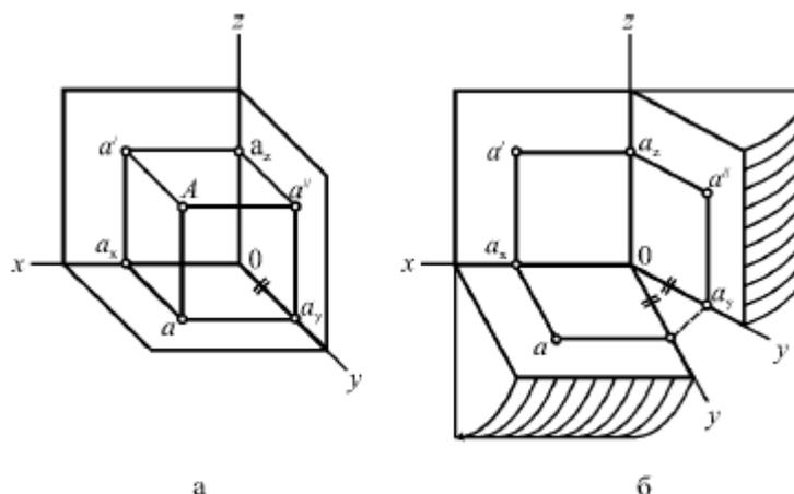
Рис. 15. построение профильной плоскости
