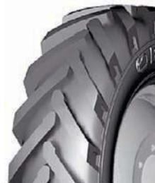
Шина для сельхозмашин. Рисунок протектора повышенной проходимости. Диагональная. Посадочный диаметр, дюйм: 16.
