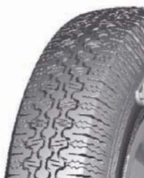
Дорожный рисунок протектора. Камерная. Посадочный диаметр, дюйм: 15.
