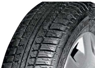
Дорожный рисунок протектора. Посадочный диаметр, дюйм: 15.
