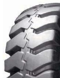
Шина для строительной и дорожной техники. Карьерный рисунок протектора. Диагональная. Посадочный диаметр, дюйм: 39.
