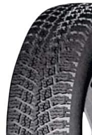
Зимняя нешипуемая шина. Направленный рисунок протектора. Посадочный диаметр, дюйм: 14.
