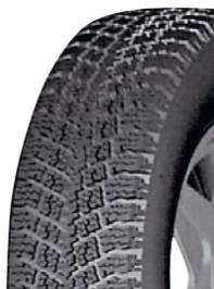
Зимняя нешипуемая шина. Направленный рисунок протектора. Посадочный диаметр, дюйм: 14.
