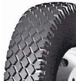
Шина для комбинированных условий. Универсальный рисунок протектора. Камерная. Посадочный диаметр, дюйм: 20.
