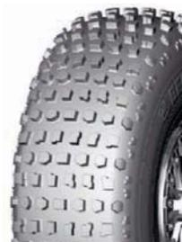
Шина для сельхозмашин. Рисунок протектора повышенной проходимости. Диагональная. Посадочный диаметр, дюйм: 18.
