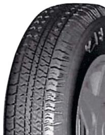
Всесезонный рисунок протектора. Посадочный диаметр, дюйм: 14.
