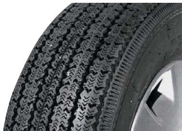
Дорожный рисунок протектора. Посадочный диаметр, дюйм: 14.
