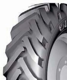
Шина для сельхозмашин. Рисунок протектора повышенной проходимости. Диагональная. Посадочный диаметр, дюйм: 16.
