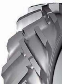
Шина для сельхозмашин. Рисунок протектора повышенной проходимости. Камерная. Посадочный диаметр, дюйм: 30.
