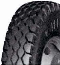
Универсальный рисунок протектора. Камерная. Посадочный диаметр, дюйм: 20.
