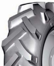
Шина для сельхозмашин. Рисунок протектора повышенной проходимости. Диагональная. Посадочный диаметр, дюйм: 20.
