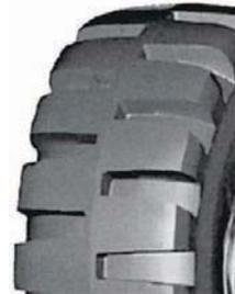
Шина для строительной и дорожной техники. Карьерный рисунок протектора. Диагональная. Посадочный диаметр, дюйм: 33.
