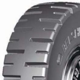
Шина для погрузочно-транспортных средств. Универсальный рисунок протектора. Суперэластик. Посадочный диаметр, дюйм: 10.
