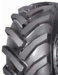
Шина для сельхозмашин. Рисунок протектора повышенной проходимости. Камерное и бескамерное исполнение. Посадочный диаметр, дюйм: 26.
