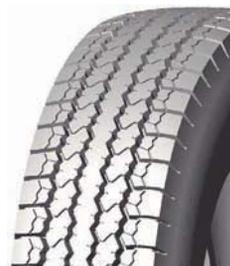
Дорожный рисунок протектора. ЦМК. Посадочный диаметр, дюйм: 17,5.
