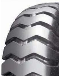
Шина для большегрузных автомобилей. Карьерный рисунок протектора. Диагональная. Посадочный диаметр, дюйм: 35.
