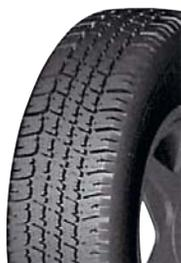
Всесезонный рисунок протектора. Посадочный диаметр, дюйм: 15.
