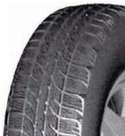
Всесезонный рисунок протектора. Посадочный диаметр, дюйм: 14.
