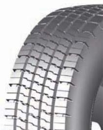
Универсальный рисунок протектора. ЦМК. Посадочный диаметр, дюйм: 22,5.
