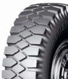
Шина для погрузочно-транспортных средств. Универсальный рисунок протектора. Диагональная. Посадочный диаметр, дюйм: 8.
