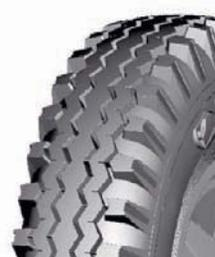
Универсальный рисунок протектора. Диагональная. Посадочный диаметр, дюйм: 15.
