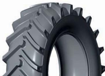
Шина для сельхозмашин. Рисунок протектора повышенной проходимости. Камерная. Посадочный диаметр, дюйм: 34.
