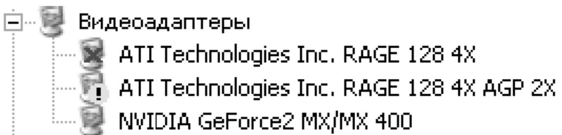
**Рис. 2.17.** Отображение состояния устройства с помощью пиктограмм
