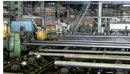
автоматизированная машина для клеймения рельсов, которая наносит клеймо в соответствии с мировыми стандартами, а также линия неразрушающего контроля рельсов, обеспечивающая 100%-ный автоматический контроль качества железнодорожных рельсов.
