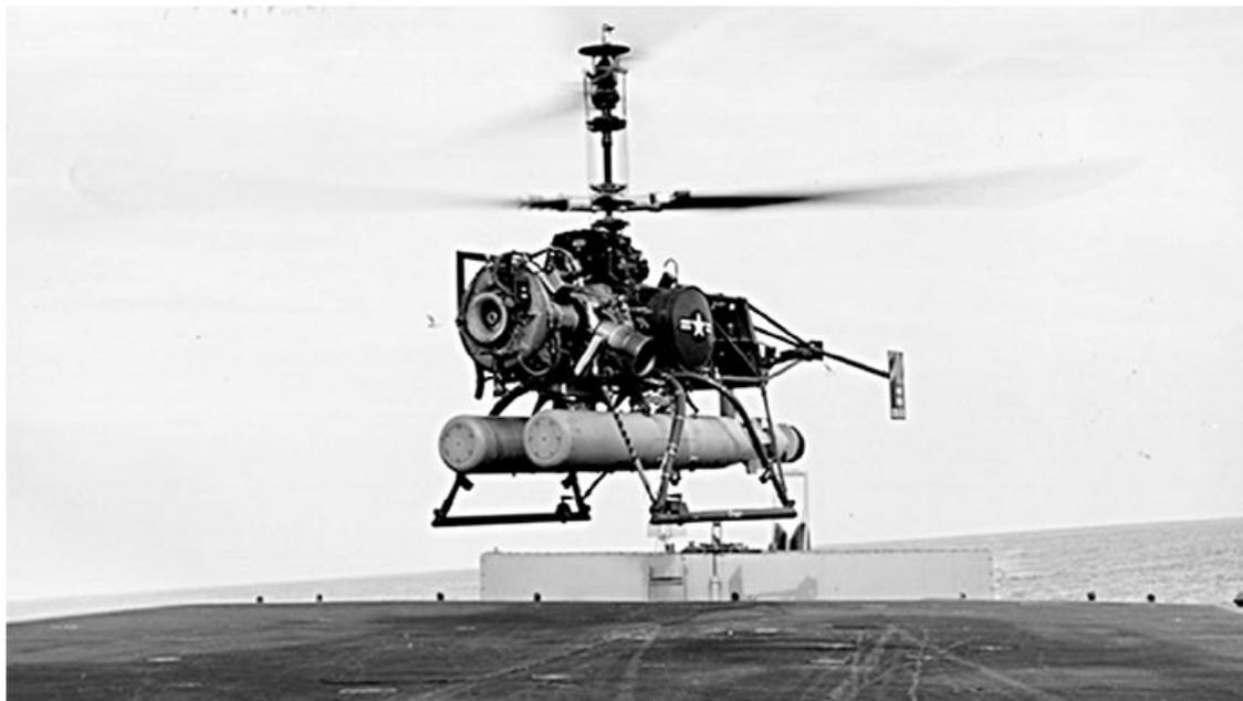
Беспилотный противолодочный вертолёт Gyrodyne QH-50 DASH (Drone Anti-Submarine Helicopter) спроектирован на базе пилотируемого вертолета Gyrodyne Rotorcycle, разработанного для ВМФ США.
