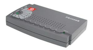
Рис. 1.3. Типичный коммутатор для домашней сети
